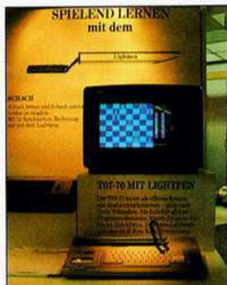
Der TO 7-70 von Thomson ist bedienerfreundlich durch den eingebauten Light-Pen.
